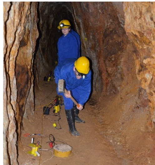
2. ábra. Szeizmikus mérések a bányában
